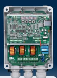
RGM è un regolatore digitale multifunzione progettato per il controllo proporzionale e PID della velocità di motori asincroni trifase ad alto scorrimento, utilizzati in ventilatori assiali, radiali e centrifughi per applicazioni HVAC&R industriali. Il principio di regolazione si basa sulla parzializzazione a taglio di fase bilanciata, che consente un controllo fluido, preciso e ottimizzato, migliorando l'efficienza energetica e riducendo l'usura dei componenti.
