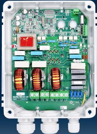
VTS è un **regolatore digitale** progettato per il **controllo della velocità di motori asincroni trifase** ad alto scorrimento, utilizzati su ventilatori assiali, radiali o centrifughi in applicazioni **HVAC&R e industriali**. Il principio di regolazione si basa sulla **parzializzazione a taglio di fase bilanciata** con la rete, che consente un **controllo preciso e dinamico**, **migliorando l'efficienza energetica** e riducendo l'usura elettrica e meccanica dei componenti.
