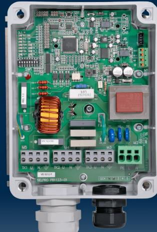
EMC è un regolatore slave monofase progettato per **operare esclusivamente** tramite protocollo **Modbus RTU**, consentendo al controllore master di gestire in tempo reale tutti i parametri operativi, sia in lettura che in scrittura. **Ideale** per il controllo di **ventilatori monofase** in impianti **HVAC&R**, offre un sistema di regolazione della velocità preciso ed efficiente.
