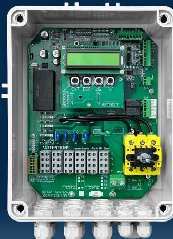
ECD è un **quadro digitale compatto e multifunzione** progettato per il **controllo intelligente dei motori EC** in impianti **HVAC&R** come **drycooler, condensatori remoti e fan-grid**. Disponibile nelle **versioni da 25 A o 32 A**, si adatta facilmente a configurazioni sia **monofase** che **trifase**, semplificando la **progettazione e l'unificazione dei quadri di potenza**.
